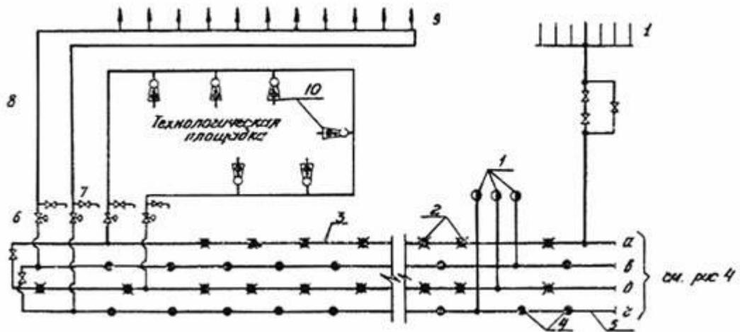
**Рис. 1. Принципиальная схема САПЗ с водяной завесой**
