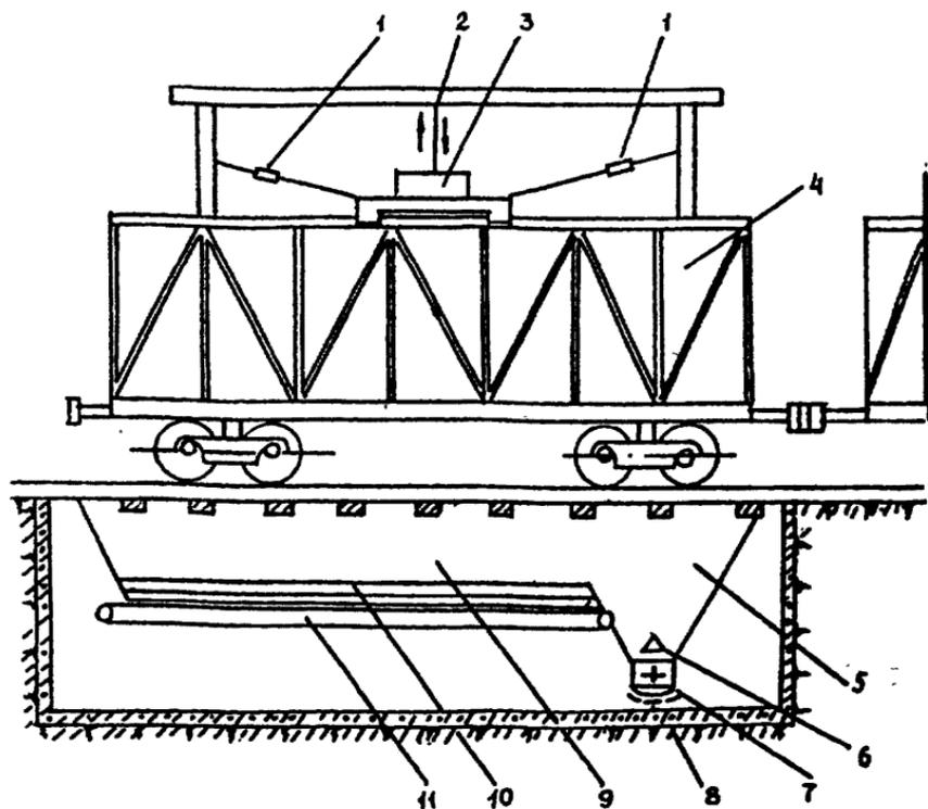
Рис. 12. Схема разгрузки с использованием виброплиты и щелевого бункера: 1 — расчалки с амортизаторами; 2 — подвеска накладной виброплиты; 3 — накладная виброплита; 4 — полувагон; 5 — основной бункер; 6 — вставка основного бункера; 7 — комкорыхлитель; 8 — выносной конвейер; 9 — щелевой бункер; 10 — вставка щелевого бунера; 11 — подщелевой конвейер
