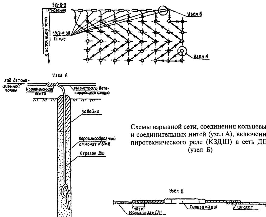
Схемы взрывной сети, соединения кольцевых и соединительных нитей (узел А), включения пиротехнического реле (КЗДШ) в сеть ДШ (узел Б)
