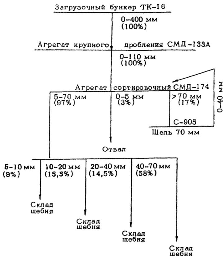
Схема технологического процесса дробления
