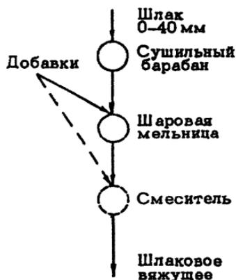
Рис. 14. Схема получения шлакового вяжущего
