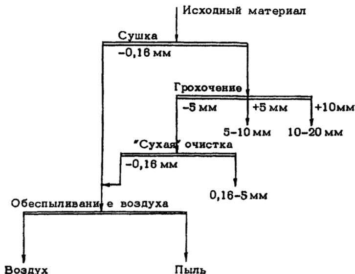
Рис. 7. Технологическая схема «сухого» обогащения влажных отсеков дробления
