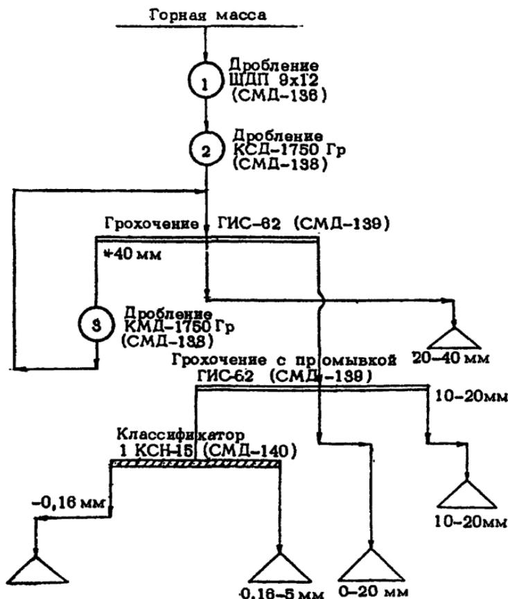
Рис. 5. Сборно-разборная дробильно-сортировочная автоматизированная линия САДЛ-И-400
