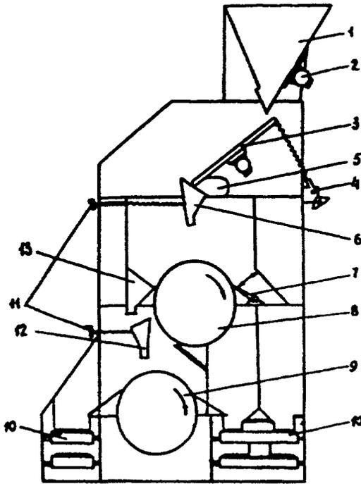
Схема двухбаранного механического классификатора ДБК-20:
