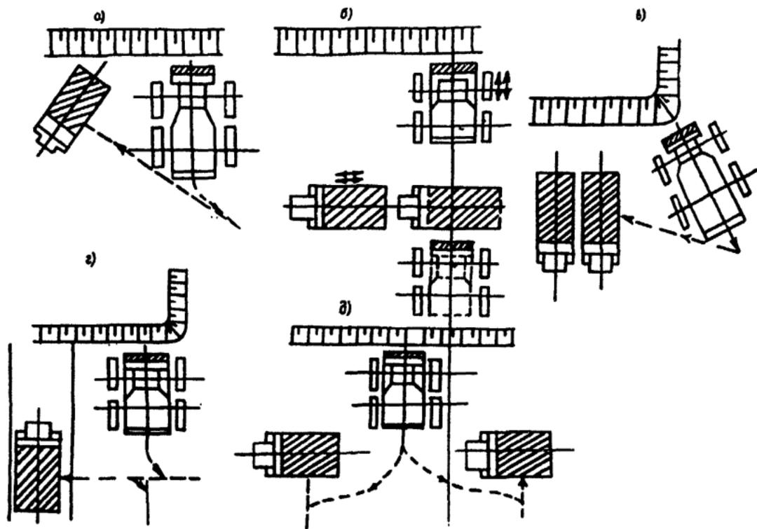
Рис 2 Схема работы погрузчика
