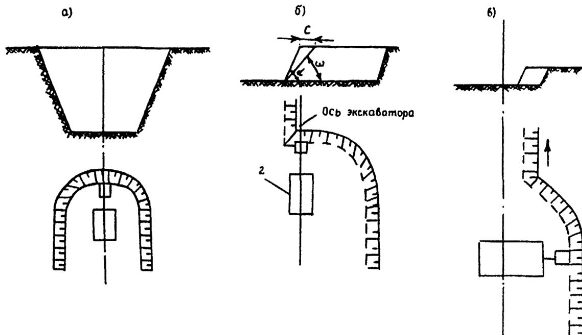
Рис. 1. Схема работы экскаватора с прямой лопатой с забоем: а — тупиковым, б — боковым; в — фронтальным: 1 — забой; 2 — экскаватор;  $\alpha$  — угол откоса рабочего уступа;  $\omega$  — угол устойчивого откоса уступа траншей;  $c$  — объем снимаемого материала
