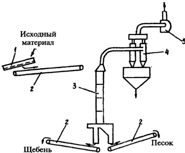
Рис. 4. Схема технологической линии ВНИИнеруда для переработки отсеков дробления «сухим» способом:
