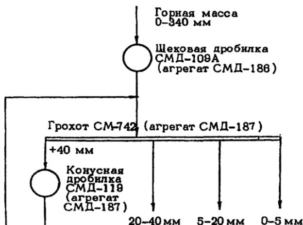
Рис. 3. Технологическая схема переработки каменных материалов на ПДСУ-35
