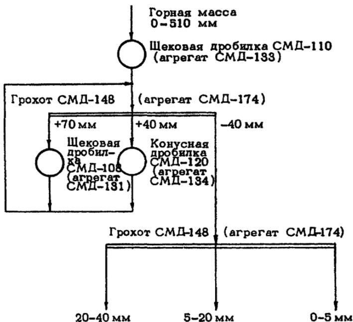
Рис. 4 Технологическая схема переработки каменных материалов на ПДСУ-85
