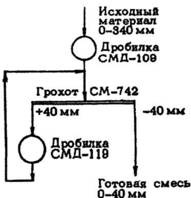
Рис. 9. Технологическая схема производства готовых смесей на ПДСУ-35
