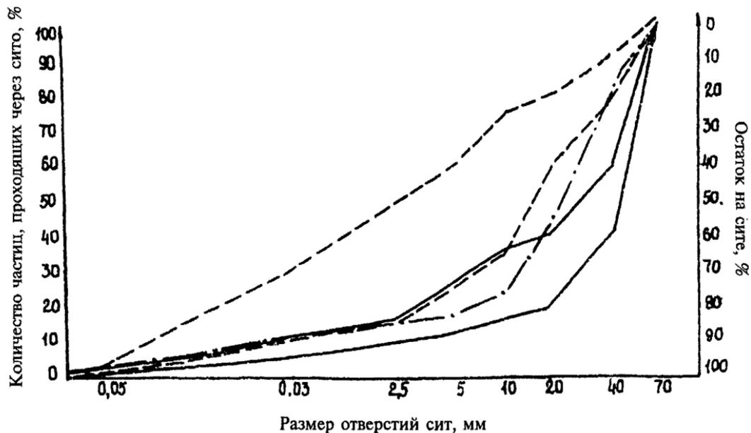
Суммарные кривые зернового состава: — — — — — кривая природной смеси; - - - - - предельные кривые гравийной смеси № 1 в подстилающем слое; — — — — — то же, в основании
