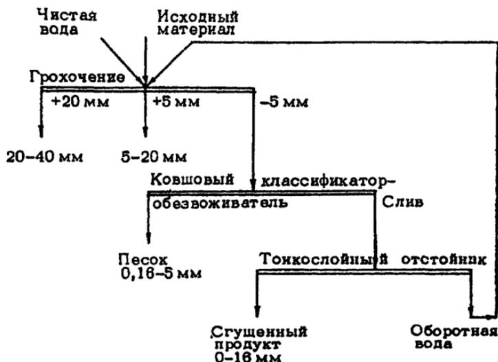
Рис. 6. Технологическая схема «мокрого» обогащения от отсевов дробления
