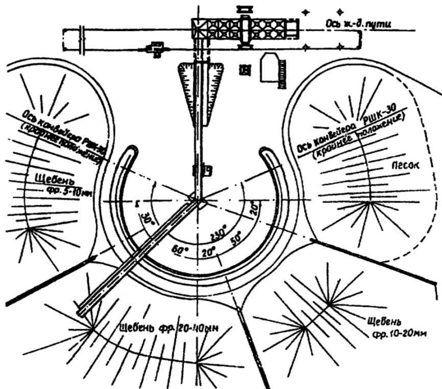
Рис. 13. Схема склада нерудных материалов вместимостью 18 тыс. м<sup>3</sup>
